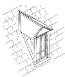
Lucarne pignon bâtie en bois
